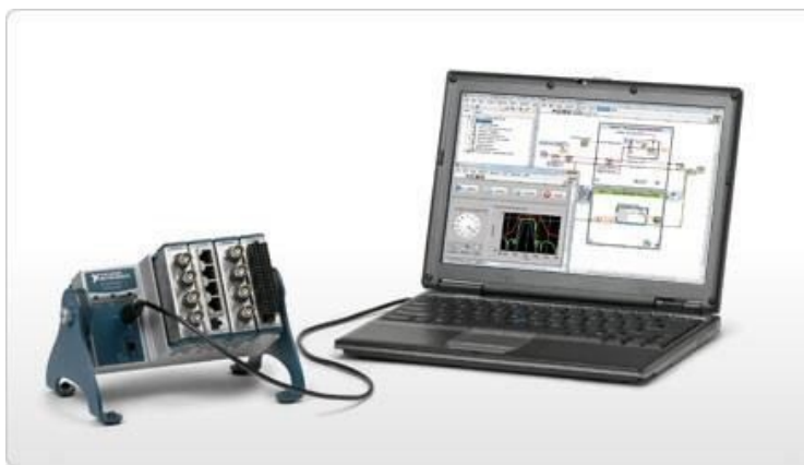
Obrázek 7 - System CompactDAQ společnosti National Instruments
