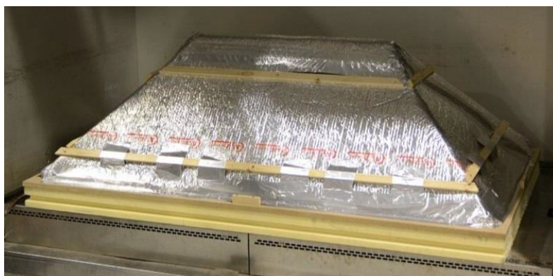
Obrázek 11 - Konstrukce izolovaná 1 vrstvou Aluthermo Quattro®
