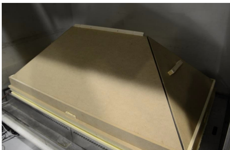
Obrázek 12 - Zateplená konstrukce krytá replikou střechy
