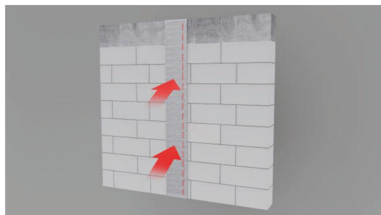
Pro instalaci **Aluthermo® QUATTRO** na stěnu je třeba povrch izolace důkladně očistit od veškerých nečistot. Je třeba ji rovnoměrně přitlačit ke stěně po celé ploše, aby pevně přilnula ke zdivu.
