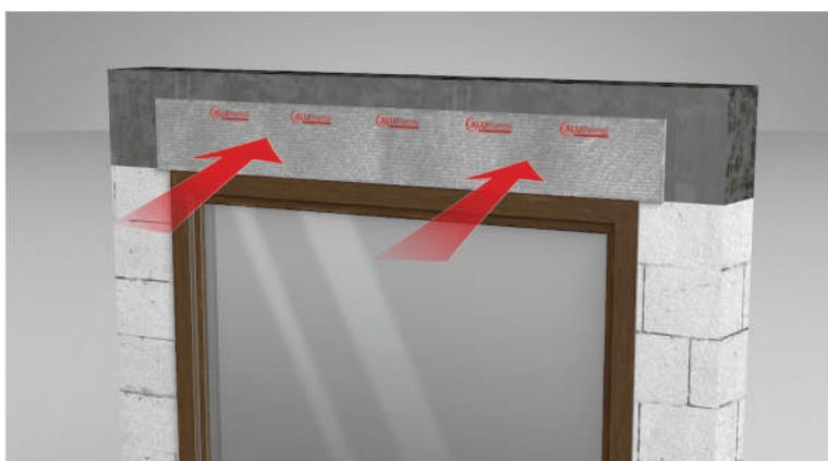
Pro instalaci **Aluthermo® QUATTRO** na nadpraží je třeba povrch izolace **důkladně očistit** od veškerých nečistot. Na suchý a čistý povrch **naneste systémové lepidlo Aluthermo®**, a rozetřete ho uprostřed a po okrajích izolace. Izolaci s naneseným lepidlem je **třeba rovnoměrně přitisknout** k nadpraží po celé ploše, aby pevně přilnula k izolovanému nadpraží.
